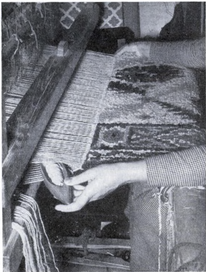
FOTO 2 - Come viene fatta passare la spola tra le fila dell'ordito, distanziate dall'alzarsi di un liccio e dall'abbassarsi dell'altro (i licci sono visibili sullo sfondo, mentre in basso è visibile parte della pedaliera che li comanda). Occorre un po' di pratica per lanciare con un colpo deciso la spola da una parte all'altra, ma è una cosa che s'impara presto. La spola è uguale a quella usata per la tessitura: una specie di navicella di legno duro, nel cui interno è aperto il vano per il canotto, sul quale è avvolto il filo della trama. Il canotto è costituito da un tondino nelle cui estremità opposte sono infissi pezzetti di robusto filo di ferro che s'impegnano in appositi alloggi, nella spola fatti, nei quali possono girare liberamente. Il filo passa all'esterno da un foro aperto nel fianco della spola, che deve essere di misure non eccessive, ma tali da non costringere a sostituire di continuo il canotto.
