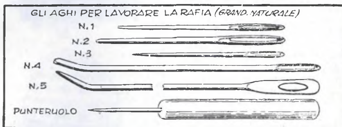
Tavola II — Questi tutti gli utensili occorrenti per lavorare la rafia. Dato che il tessuto sul quale si opera è generalmente a trama rada, non occorre neppure un dito per aiutare a spingere l'ago. Gli aghi, come l'illustrazione mostra, sono normali aghi da lana o da tappezziere
