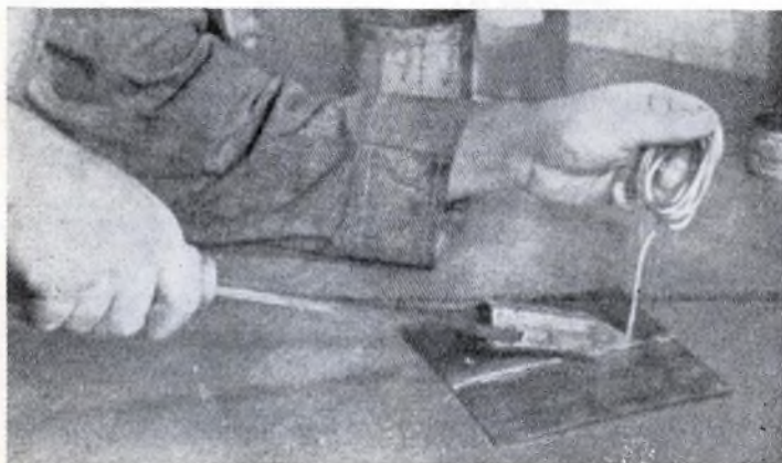
Foto 8 - La saldatura deve essere applicata proprio sul davanti del ferro da saldare. Questo deve essere tanto caldo da fonderla quando, procedendo lungo il giunto, ne viene a contatto.
