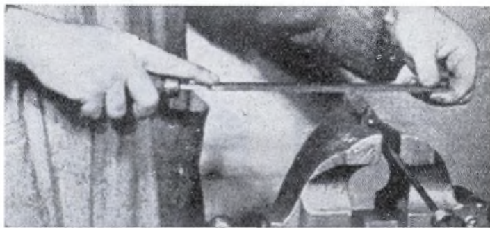
Foto 2 - Dopo aver esposto il ferro al calore, è consigliabile passarlo con la lima per asportare lo strato di ossido eventualmente formatosi: il metallo deve apparire ben lucido.
