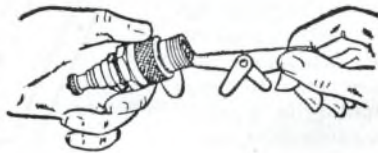
FIG. 2 - Quando controllate la luce tra le punte di una candela, fate attenzione a non spostare l'elettrodo centrale.
