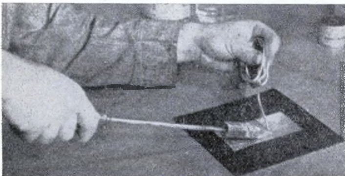
Foto 15 - Quando si voglia saldare una lastra ad un'altra, una delle superfici viene rivestita di un leggero strato di saldatura
