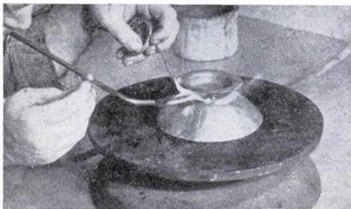
Foto 14 - Saldatura del piede ad una coppa: è utilissimo servirsi di un piano girevole, che permette l'agevole applicazione del calore tutto intorno al giunto.
