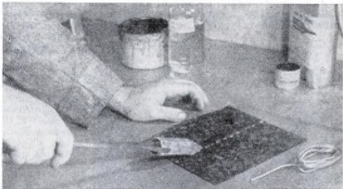
Foto 9 - Per eseguire una saldatura a punti, piccoli pezzi di saldatura sono disposti lungo tutto il giunto, quindi fatti fondere con il ferro ben caldo uno dopo l'altro.
