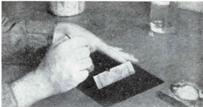
Fig. 2. - Come si applica il flux ad un giunto mediante un pennellino. Si tratta di saldare il bordo di una scatola triangolare. I pezzi sono tenuti insieme con due legature di filo ossidato.
