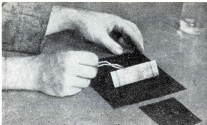
Fig. 3 - Sul giunto di cui alla figura precedente, già spalmato con il flux, vengono disposti i pezzetti della saldatura mediante una piccola pinza.
