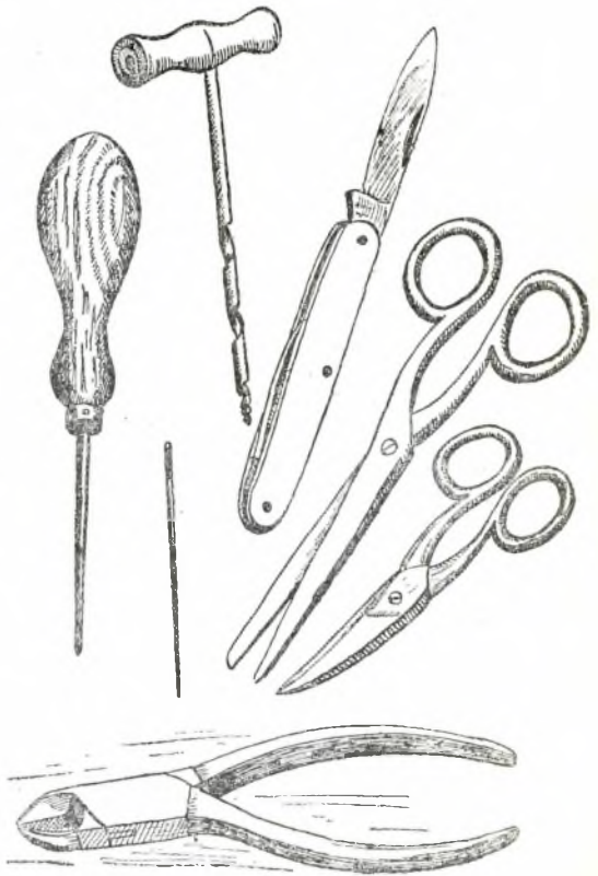
Fig. 4 - Gli utensili poi... un succhiello, un temperino, forbici, una lesina, aghi... La cosa più complessa e costosa è la pinza. Per qualche progetto occorre anche una piccola lima sottile a legno.
