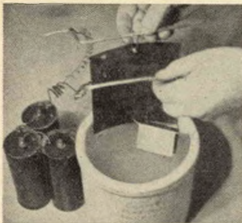
Fig. 8 - Per preparare il bagno, tutto quello che occorre ad un dietante è un recipiente di terracotta o porcellana o vetro e tre pile, da collegare in serie. Dopo i primi tentativi, il successo è sicuro, a condizione di rispettare rigorosamente le norme. Imparare a ramare piccoli oggetti può tornare prezioso in mille occasioni. Inoltre saranno i primi passi nell'acquisizione dei segreti di una tecnica di grande importanza.
