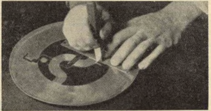
Fig. 4 - Una volta applicata la vernice, si correggono i contorni del disegno con un temperino. Per i tratti dritti è di grande aiuto una riga.
