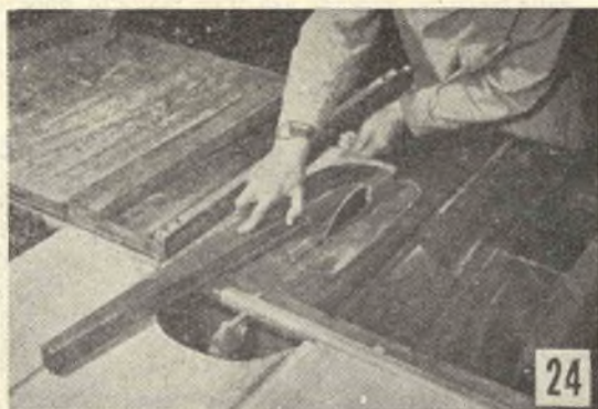
LE GAMBE. Il taglio ad angolo per l'unione dell'estremità delle gambe e delle traverse va fatto dopo che le gambe stesse siano state tagliate con una sega a nastro per seguire i contorni del modello. Il legname deve essere lungo 100 mm. e dello spessore di 35 mm. In questa foto si può vedere in funzione la forma indicata nel dettaglio a destra della fig. 23.
