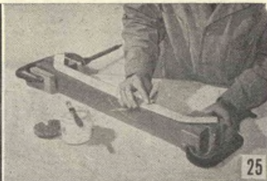
LE TRAVERSE. Per ottenere lo spessore necessario per potervi ricavare i pezzi curvi necessiterà incollare insieme più blocchi di legno. Anche questo legname deve essere dello spessore di 35 mm. mentre la sua larghezza deve essere di 77 mm. circa. Quando la colla avrà fatto presa tagliare le estremità con la sega a nastro. Evitare assolutamente l'uso di chiodi.
