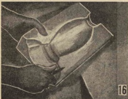
Scavare con cura nelle prime due parti dello stampo, le scanalature per l'allineamento, della terza parte. Quando le prime due parti verranno affiancate, le scanalature di cui sopra non dovranno presentare dei punti sotto squadra.
