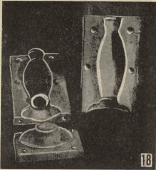
Lo stampo completo, in tre parti. Notare le guide per l'allineamento.
