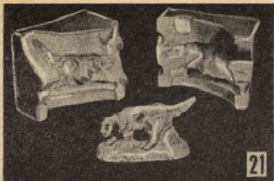
Oggetti di forma complicata possono essere colati in stampi a soli due pezzi, è necessario però che sia studiata con cura la linea di separazione tra le due parti dello stampo.
