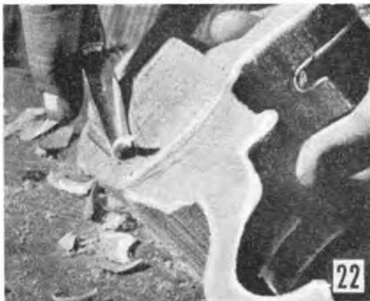
Servirsi di una sgorbia per lavorare all'interno dei lobo degli orecchi. Consultare spesso i disegni o le foto per assicurarsi del buon andamento del lavoro.
