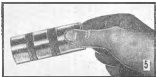
Ecco un esempio: un tubo di alluminio su cui potete vedere due strisce anodizzate e colorate. Dopo questo trattamento ed il successivo fissaggio, eliminate con un adatto solvente la vernice di riserva.
