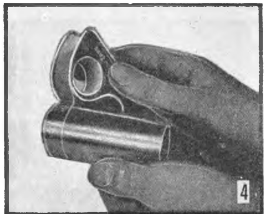
Potete servirvi delle strisce di nastro adesivo tipo Scotch Tape, anche come guida per la successiva applicazione della vernice di riserva (quella che dovrà coprire tutti i punti che non desiderate che vengano anodizzati).
