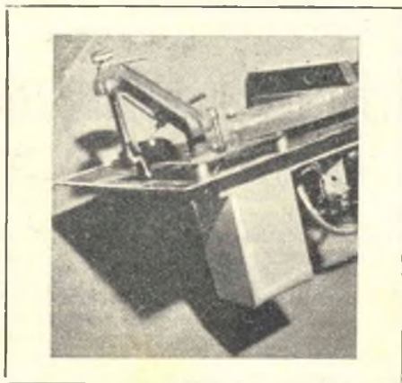
Foto ravvicinata, scattata sul perno del pick-up, per mostrare l'interruttore (Z) e la leva (I) che solleva dal disco il pick-up stesso, allorché inizia il ciclo per il cambio del disco.
