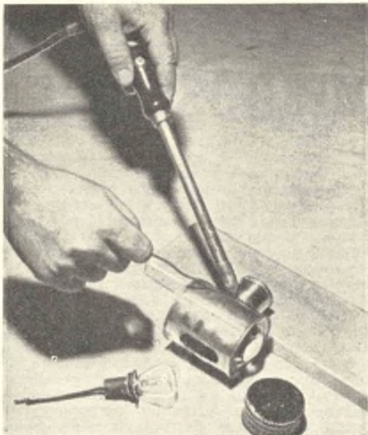
Saldatura del pezzo di tubo destinato ad agire come camino, per creare la corrente di aria di ventilazione. Il foro oblunco, situato in posizione diametralmente opposta a quello per l'aerazione deve essere abbastanza grande per lasciare passare il portalampane.
