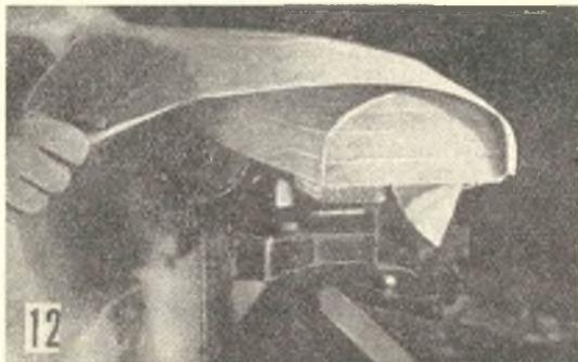
La pressione della plastica riscaldata sulla forma la si esegue con l'aiuto di un pezzo di stoffa sottile e resistente, stesa sulla plastica e tirata dai suoi lembi opposti.
