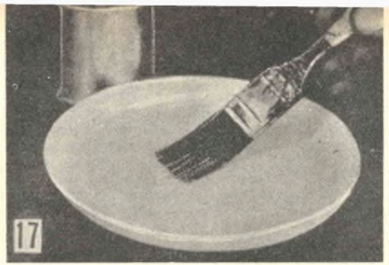
Foto n. 16. - Altro sistema per l'incollatura di due parti in plastica: le parti in questione sono tenute una contro l'altra da un paio di pinzette da biancheria; indi, contro di esse viene fatta cadere qualche goccia di solvente adatto. Foto n. 17. - Per eseguire le incisioni a solvente, la plastica va prima coperta con uno straterello di paraffina, applicata fusa con un pennellino, il disegno da incidere viene poi marcato con una lama, in modo da asportare lungo di esso la paraffina mettendo allo scoperto la sottostante plastica. Successivamente non c'è che da applicare il solvente, lasciarlo agire per il tempo necessario e poi asportare mediante acqua poco più che tiepida la paraffina rimasta.
