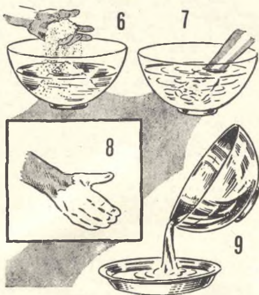
Fig. 6. - Il gesso in polvere viene fatto cadere nell'acqua permettendogli di scorrere attraverso le dita, allo scopo di eliminare i grumi. Fig. 7. - Mescolare il gesso agitando le dita della mano tenute sotto la superficie del liquido, senza permettere che affiorino. Fig. 8. - Quando è pronto per la colata, l'impasto di gesso forma uno straterello uniforme sulla mano estratta da esso. Figura 9. - Appena il gesso è pronto non si deve attendere altro tempo e lo si deve subito colare negli stampi.
