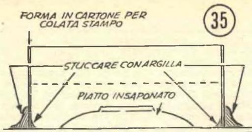
35) Veduta in sezione della disposizione, comprendente il piatto, il cilindro di cartone e le stuccature eseguite con argilla. La linea orizzontale, tratteggiata, indica il livello che dovrà essere raggiunto dall'impasto di gesso versato nella forma per la colata.
