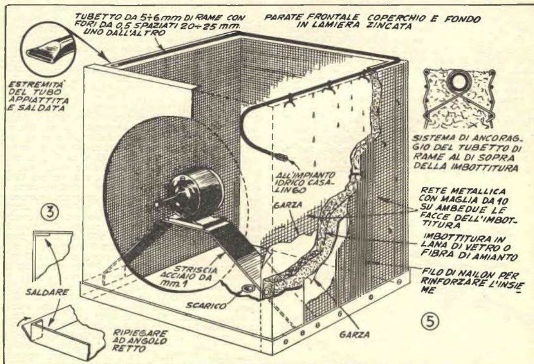
Fig. 3. - Sistema per formare il fondo, a tenuta d'acqua, del condizionatore, onde raccogliere l'acqua che non evaporata sia passata attraverso tutta l'imbottitura. I bordi vanno ripiegati ad angolo retto e gli spigoli vanno saldati a stagno. Al centro del fondo si trova un foro per lo scarico dell'acqua.
