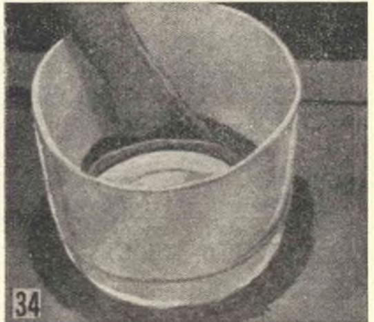
34) Preparazione della forma cilindrica per la colata. La forma si realizza con una striscia di cartone curvata e legata. L'orlo inferiore della forma va stuccato, internamente ed esternamente con dell'argilla molto plastica.
