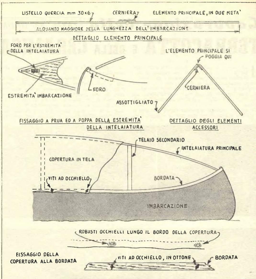
*Dettagli costruttivi della copertura. In alto figura l'intelaiatura di legno per il sostegno del telone. Tutte le varie parti possono essere ripiegate al fine di occupare il minimo spazio e riposte in un angolo del fondo dello scafo.*
