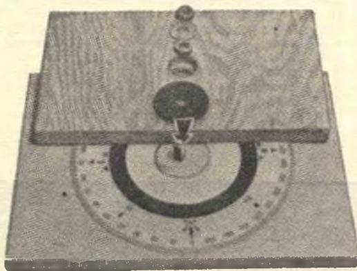
Come un semplice ricevitore portatile con antenna può essere adattato per funzionare come radiogoniometro e servire ottimamente per i rilevamenti di posizione e di direzione. La freccia che sporge dalla parte centrale della custodia corrisponde alla perpendicolare del piano su cui si trova la stazione allorchè essa viene ricevuta con la minima intensità.
