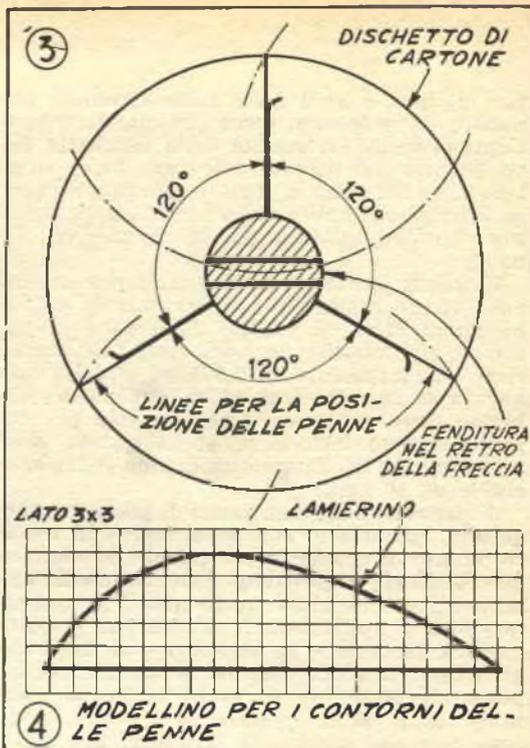
Fig. 3 - Modellino in cartone per la rapida messa in opera dei tre pezzetti di penna, in modo che ciascuno di essi forma con quelli adiacenti, un angolo di 120° Fig. 4 - Modellino per il taglio del contorno delle penne stabilizzatrici.
