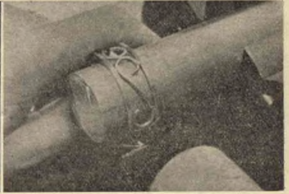
Foto a sinistra: Altro sistema inteso a trattenerle al loro posto le varie parti allorché si deve procedere alla saldatura: le legature provvisorie illustrate sono eseguite con filo di ferro assai sottile, possibilmente ossidato, per evitare che possa essere bloccato anche esso con la saldatura. Foto a destra: Ultimata la saldatura si provvede a curvare il braccialetto, per metterlo in condizioni di essere accolto sul polso. Come supporto usare un pezzo di tondino di legno e come martello, uno con testa di legno duro.
