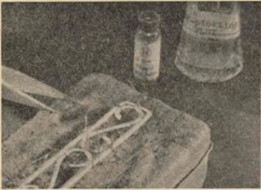
Foto a sinistra: Altro sistema inteso a trattenerle al loro posto le varie parti allorché si deve procedere alla saldatura: le legature provvisorie illustrate sono eseguite con filo di ferro assai sottile, possibilmente ossidato, per evitare che possa essere bloccato anche esso con la saldatura. Foto a destra: Ultimata la saldatura si provvede a curvare il braccialetto, per metterlo in condizioni di essere accolto sul polso. Come supporto usare un pezzo di tondino di legno e come martello, uno con testa di legno duro.
