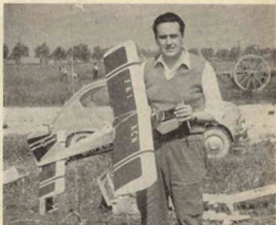
Una felice realizzazione di Rosa Rosa Gioacchino. Modello radiocomandato con comando proporzionale. Ricevitore Gazistor autocostruito con valvole XFGI e transistor OC 70. Apertura o.ore mm. 1400 - Peso gr. 1700 - Motore K e B torpedo 19 cc. 3,28.
