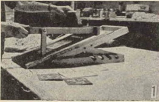
Fig. 1: Lo schermo di seta in funzione, montato sulla sua intelaiatura: osservare la posizione inclinata del piano di lavoro, nonché il blocchetto di legno che trattiene momentaneamente sollevato lo schermo, durante la sostituzione dei fogli stampati con quelli da stampare. — Fig. 2: Questa è la maniera corretta di tenere la spatola per farla scorrere lungo tutto lo schermo, con movimento diretto verso la persona che sta al lavoro. La spatola deve essere tenuta alquanto inclinata in avanti: se fosse infatti ad angolo retto con lo schermo, trascinerrebbe l'inchiostro senza forzarlo a passare attraverso lo schermo stesso.
