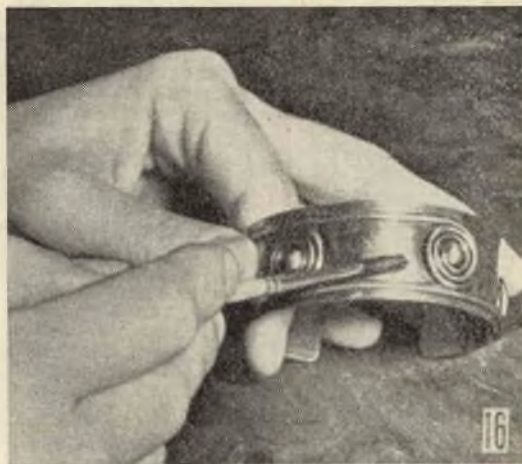
Fig. 15: Alcuni motivi decorativi possono poi anche essere sbalzati sul monile per mezzo di un punzone. — Fig. 16: Operazione finale, quella della applicazione di uno straterello di smalto trasparente alla nitro: tale rifinitura è molto importante nel caso di oggetti in rame, ma lo è meno, nel caso di monili in argento.
