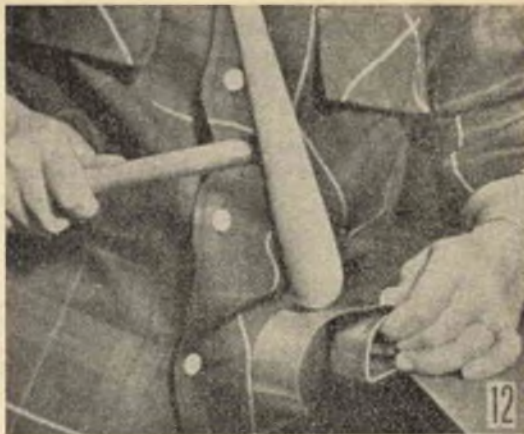
La formatura a maglie eseguirsi in sezioni, specie se la striscia di argento è di notevole spessore. Dopo avere curvato una delle sezioni, si passa a lavorare quella adiacente.
