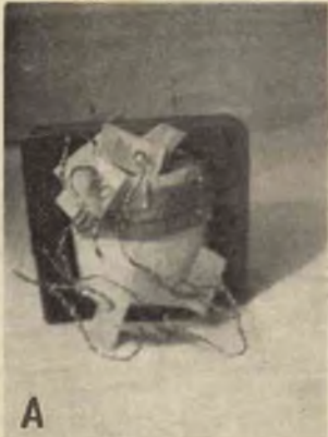
Foto A: L'autotrasformatore prima del montaggio. — Foto B: Attacato alla rete luce accende una lampadina da 4 volt. — Foto C: Accensione di una lampada al neon con 100 volt.
