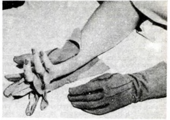
Le dita indice e pollice della mano destra sono già state completate; le altre dita sono complete, eccezion fatta per la cucitura che manca tra ciascuna delle forcelle
