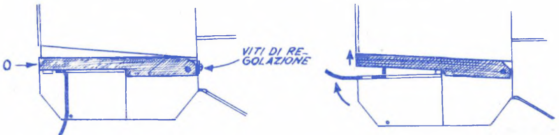
FIG. 7 FUNZIONAMENTO DEL PREMINEGATIVO E SUA REGOLAZIONE
