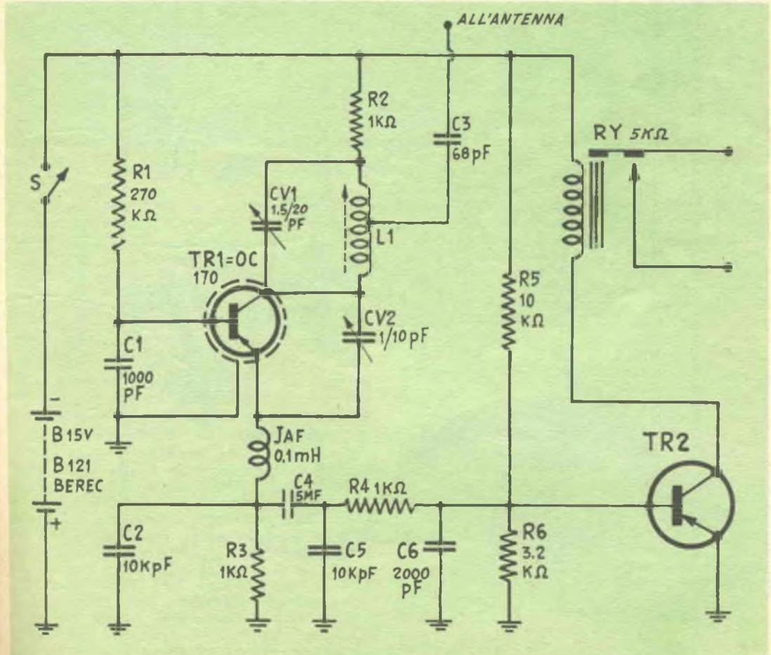
ti dalle formule, è veramente buono: il soffio generava una variazione di ben 1,2 mA sul collettore di TR2, mentre col filtro la deriva dovuta al soffio è di appena 150 micro amper.
