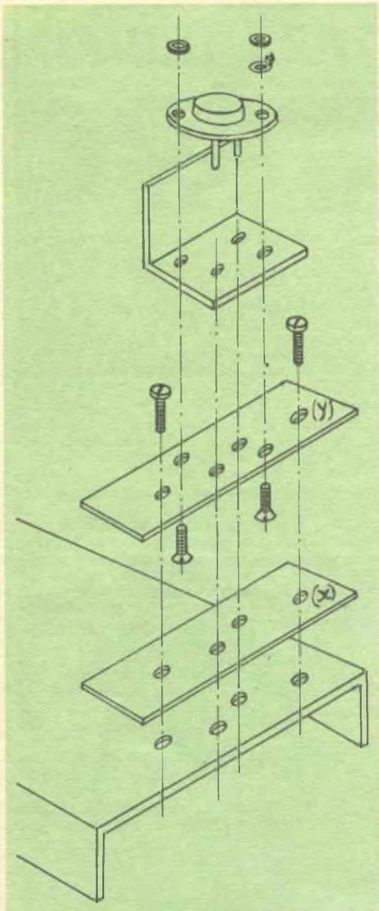
Disposizione consigliata per il montaggio del transistor (X) ed Y sono pannellini di filtra isolante
