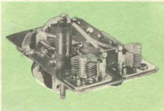
Il ricevitore visto dal di sotto; da notare i due condensatori e la bobina
