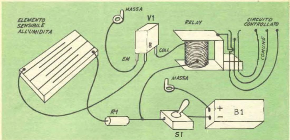
po conduttore che stabilisca tra le due metà dell'elemento, un contatto perfetto, il transistor non sia polarizzato in modo tanto energetico che ne derivi la sua autodistruzione. Nel circuito, si nota anche una batteria, che è unica per l'alimentazione di tutti gli elettrodi del transistor, ed un interruttore unipolare che ha la funzione di permettere od impedire che la corrente della batteria vada ad alimentare il complesso.
