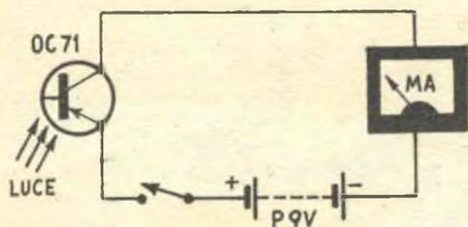
allorché la luce abbassi la resistenza interna del transistor TR la corrente della pila P fluisce attraverso l'indicatore mA, deflettendolo: sicché si ottiene direttamente la misura.
