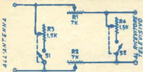
to, al pannello posteriore del televisore. Il circuito elettrico e pratico che allego, serviranno subito a fare esclamare agli esperti, che si tratta di un vero ponte di attenuazione, simile a quello che si usa in molti oscillatori modulati, di qualità elevatissima, ad ogni modo, posso assicurare che le prestazioni del complesso sono veramente egregie.
