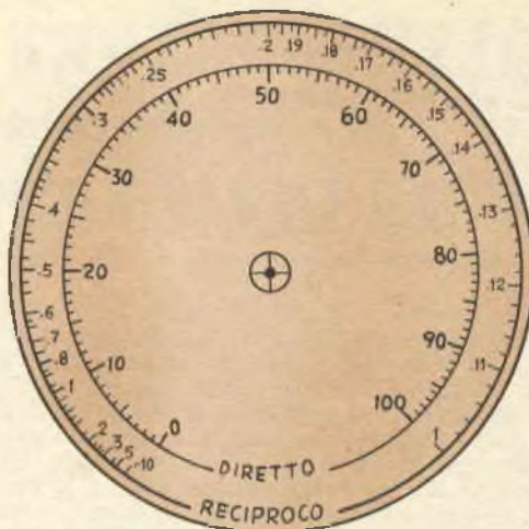
Graduazione da tracciare sul quadrante di ogni potenziometro
