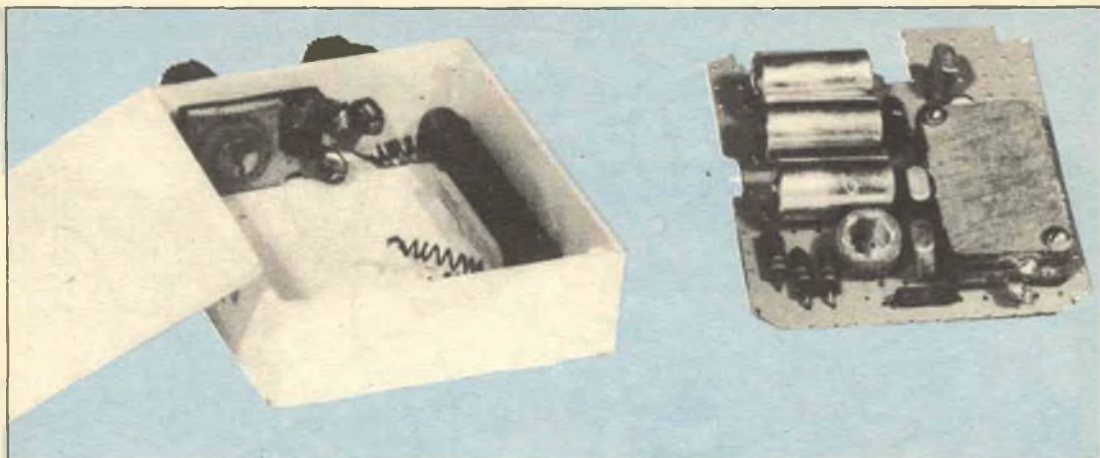
L'apparecchio personal: a sinistra, è visibile la scatoletta custodia, con alcuni dei principali componenti, ossia la antenna in ferrite con due avvolgimenti, il variabile di sintonia ed il potenziometro di reazione-volume, interruttore generale. A destra, il ricevitore montato sul suo pannellino di plastica: mostra la compattezza della disposizione delle varie parti. Visibilissimi, anche i tre transistor
