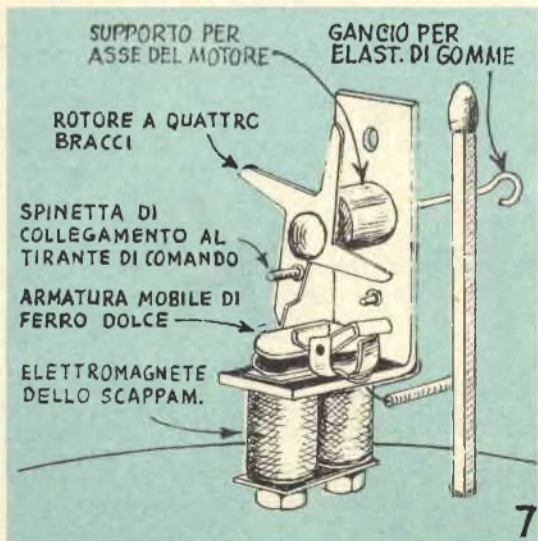
Come si presenta uno scappamento a quattro braccia. La energia per lo scappamento è fornita da un elastico di gomma. Osservare le dimensioni del meccanismo, paragonate a quelle di un fiammifero svedese
