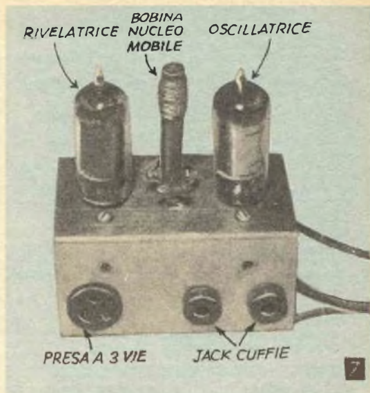
Le principali parti del complesso, già montate sullo chassis; nella parte frontale, le spinette per la cuffia e la spinetta tripolare per il collegamento all'apparecchio, della bobina cercatrice
