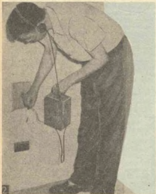
Utilizzazione tipica del cercametalli, in casa per seguire una conduttura elettrica o di gas o di acqua, sotto l'intonaco, così da potere fare la derivazione nella conduttura stessa, nel punto voluto, senza avere da danneggiare il muro nella esecuzione di ricerche a caso
