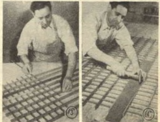
(Foto 4): Una assicella può essere usata come guida per la regolare ed uniforme spaziatura di tutti i listelli, rispetto ai tondini; per assicurare le unioni si può fare uso di chiodini mezzicapi e di piccolissimi quantitativi di colla, possibilmente poco visibili
