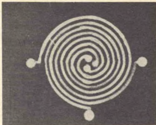
Ecco un trasformatore di radiofrequenza con nucleo di aria, formato da tre bobine ciascuna di 2,5 spire. Data la assoluta simmetria di una bobina di questo genere la si può usare ottimamente per circuiti di controfase, ecc. Per il calcolo dei valori elettrici di ciascuna delle bobine, occorre tenere presente oltre che i dati come per le precedenti, anche un coefficiente che dipende dall'accoppiamento tra di esse e dalle condizioni di carico nelle quali ognuna di esse si trova
