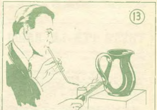
Applicazione al recipiente, del manico preparato secondo le istruzioni di cui sopra: come per saldare se ne può usare una di una torcia a gas
