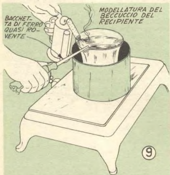
Sistema tipico per la realizzazione, sull'orlo del recipiente, di un beccuccio quale può averlo una caraffa od un recipiente simile
