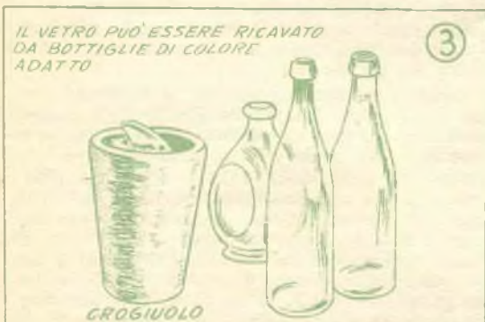
La materia prima per la soffiatura del vetro può essere ricavata con vantaggio, dalla vetreria comune, quali bottiglie dei colori voluti
