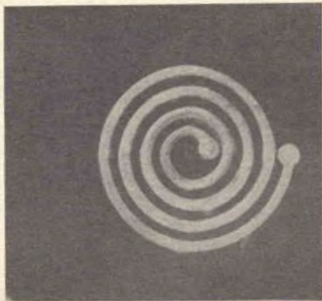
Forma caratteristica della induttanza circolare: nella figura di sinistra è la rappresentazione di una spirale, con le dimensioni che sono da tenere presenti nel calcolo e nella progettazione di induttanze di determinato valore. Per le induttanze formate da diverse spire le dimensioni tipiche si prendono in riferimento del punto centrale della spirale mediana. A destra: come si presenta una bobina circolare formata da 4 spire complete
