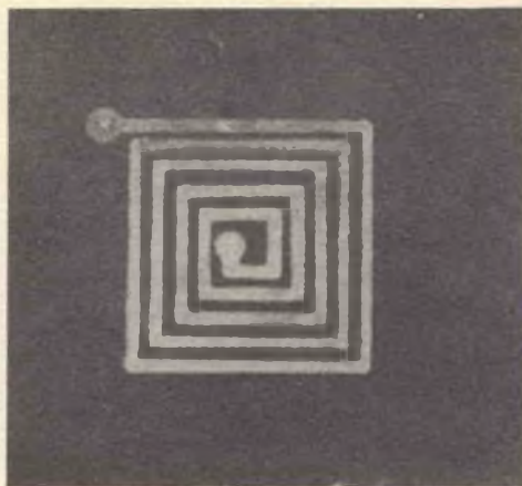
A sinistra, forma tipica di una spirale di una bobina quadrata, con le dimensioni da prendere in considerazione per i calcoli. Le dimensioni sono sempre prese dalla parte centrale della spirale mediana; è essenziale come del resto anche negli altri tipi di bobine ultraspiatte che la larghezza del conduttore sia mantenuta costante
