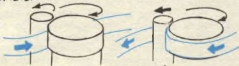
Anello di nastro, per la ripetizione continua di un rumore
