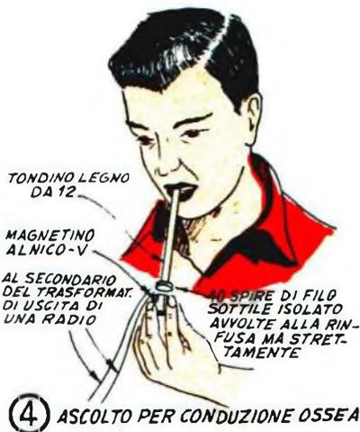
In corrispondenza del segnale, la bobinetta si metterà a vibrare e trasmetterà queste sue vibrazioni puramente meccaniche lungo la bacchetta, ai denti che afferrano questa ultima. Essendo i denti solidali alla struttura ossea della testa, attraverso di essi le vibrazioni si trasmetteranno ai nervi dell'udito, per cui la persona che esegue l'esperimento udrà chiaramente i suoni prodotti dall'apparecchio.
