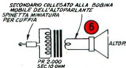
INSERIRE NEL JACK DI USCITA PER USARE COME ALTOPARLANTE, PER USARE COME MICROFONO DINAMICO INSERIRE NELL'ENTRATA
