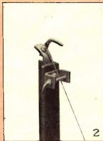
Veduta ravvicinata della estremità superiore del paletto, illustrante i dettagli del sistema di regola- zione dello strumento ed in particolare per la regola- zione della posizione laterale e della altezza del complesso del braccio oscillante e del peso, detti elementi di regolazione sono contrassegnati nella tavola costruttiva rispettivamente con le let- tere B ed A
