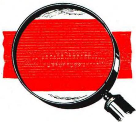
Veduta ingrandita con la lente di una registrazione effettuata dallo strumento di una scossa tellurica, di una certa intensità, avvenuta ad una distanza di circa 7000 chilometri dal punto in cui lo strumento era stato piazzato.
