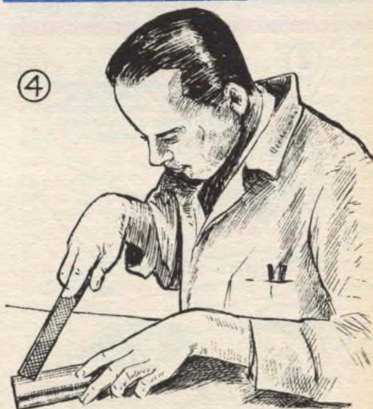
LA DUREZZA DELLA SUPERFICIE POTRA' ESSERE PROVATA CON UNA LIMA DI ACCIAIO RAPIDO
