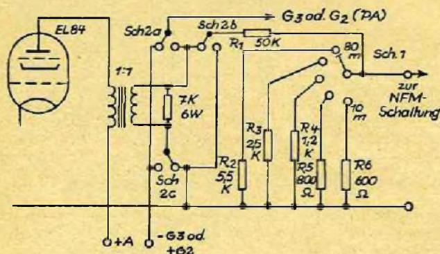
Bild 15: Darstellung der Empfangsmöglichkeit auf einer der beiden Flanken einer Resonanzkurve.
