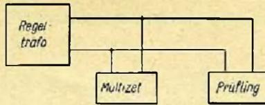
Bild 7a: Messung der Meßwerkspannung eines Instrumentes (oben)
