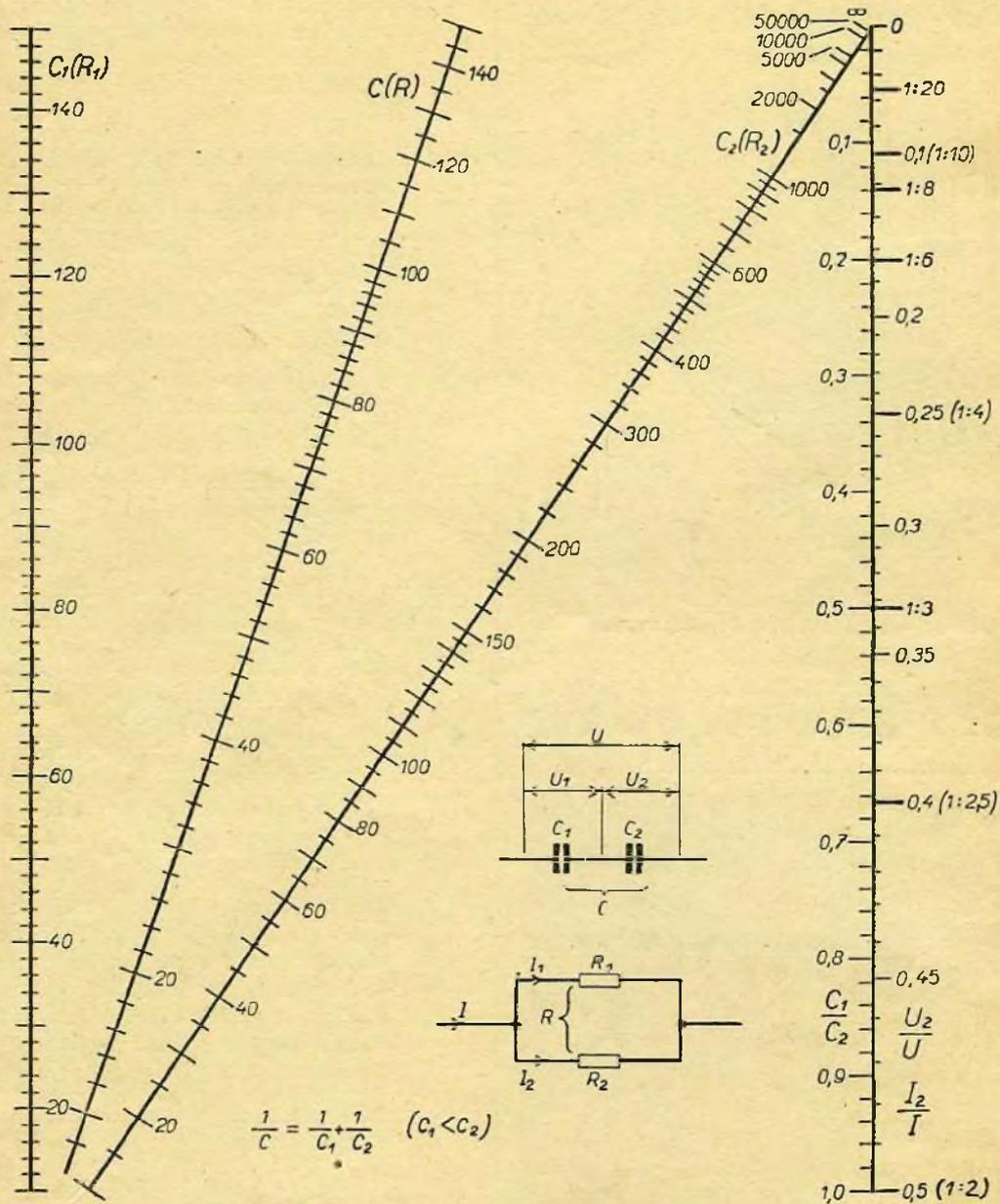
**Erklärung:** Verbindet man die gegebenen Werte der Kondensatoren (bzw. Widerstände) auf den Leitern  $C_1$  ( $R_1$ ) und  $C_2$  ( $R_2$ ), so ist der Wert im Schnittpunkt Verbindungslinie—Leiter  $C$  ( $R$ ) das gesuchte Ergebnis der Gesamtkapazität (bzw. des Gesamtwiderstandes). Wird die Verbindungslinie
