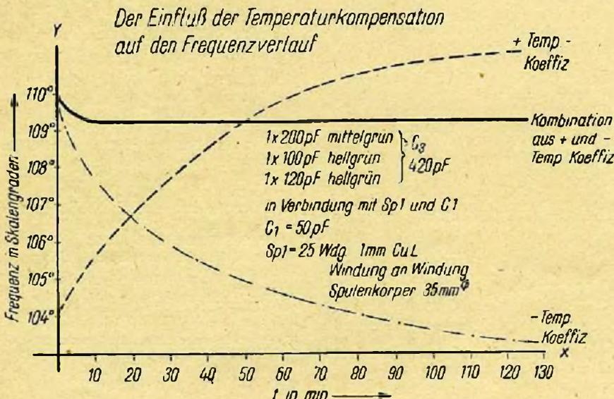
Bild 6: Der Einfluß der Temperaturkompensation auf den Frequenzverlauf
