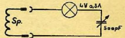
Bild 4: Schaltbild des verwendeten Absorptionsfrequenzmessers
