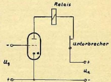
werden. Die für das Ende der Zündung notwendige Unterbrechung geschieht dann beim Wechsel der Periode des Wechselstroms. Ist die Zündspannung des Thyatrons noch erhalten, dann zündet es bei der nächsten Periode von neuem. Liegt die negative
