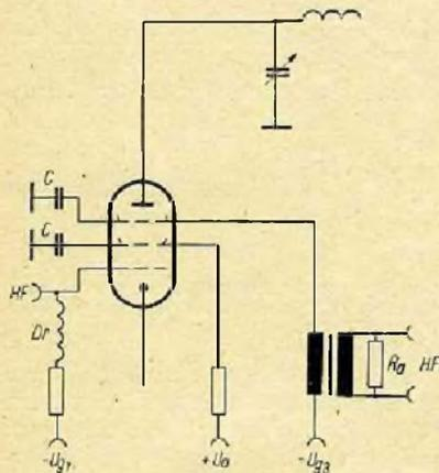
Bild 7: Prinzipialschaltbild der Bremsgittermodulation. Dieses Verfahren läßt sich nur anwenden bei PA-Röhren, deren Bremsgitter getrennt herausgeführt ist.
