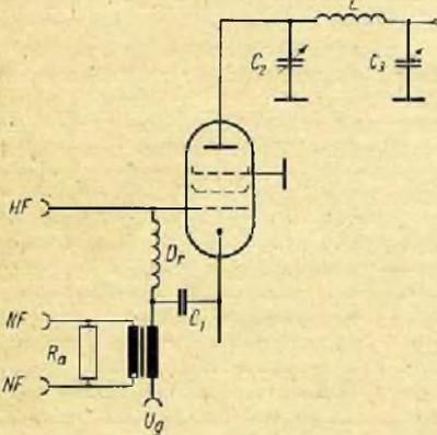
die PA selbst muß diese Aufgabe übernehmen. Das bedeutet, der unmodulierte Träger muß in seiner Leistung so weit herabgesetzt werden, daß die Röhre in den Modulationsspitzen den in den Daten verzeichneten Oberstrichwert nicht überschreitet. Der Wirkungsgrad wird verschlechtert und beträgt etwa 30 Prozent. Am Steuergitter der PA liegen die HF-Ansteuerung und die Modulationsspannung.
