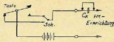
Bild 16: FSK-Einrichtung mit Umschaltmöglichkeit zwischen Trenn- und Zeichen-seite
