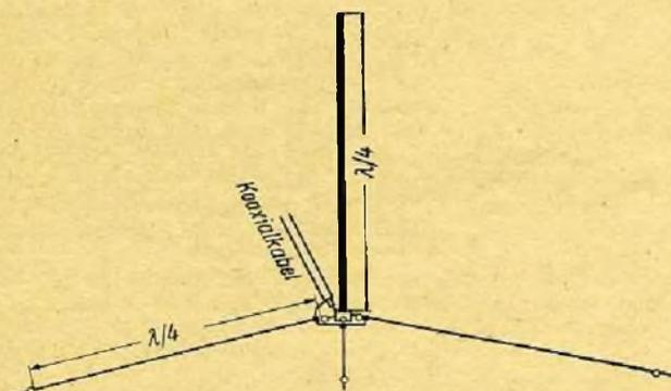
Bild 3: Darstellung der geerdeten Ground-Plane-Antenne. Der Lufttrimmer zwischen Speise- und Fußpunkt dient zur Kompensierung des induktiven Anteils.
