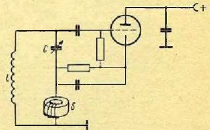
Bild 2: Schwingungsschaltung mit mechanischem Schwinger als frequenzbestimmendes Element.
