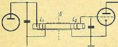
Bild 3: Filterkreis mit mechanischen Resonatoren.
