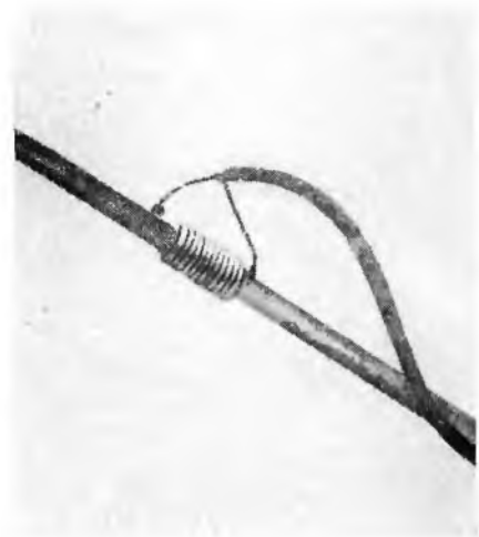
Bild 7: Kurzschlußstüb. Material für das Drehteil ist Novotext. Spule aus 2,5 mm Aludraht, an den Enden breitgeklopft und durchbohrt. Mantel und Seele des stubs an Lötösen, diese mit Spulenden am Element festgeschraubt, dick mit Duosan gegen Korrosion schützen. Spulen- \varnothing 20 mm, Windung an Windung, Kabel am Ende offen lassen! Reflektor: 12 Wdgn., stub: 2,35 m Koaxkabel. Direktor: 4\frac{1}{2} Wdgn., stub: 1,10 m Koaxkabel.
