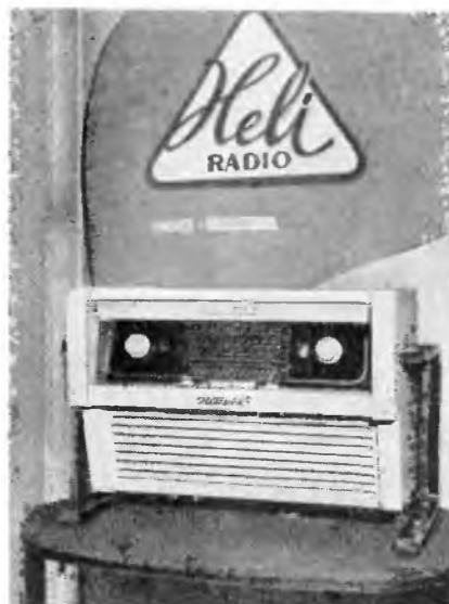
Eine etwas eigenwillige Form zeigte die Firma Hempel mit ihrem Rundfunkempfänger „Heli 3000“. Das Gerät ist mit 10 Röhren bestückt und besitzt 6/11 Kreise.
