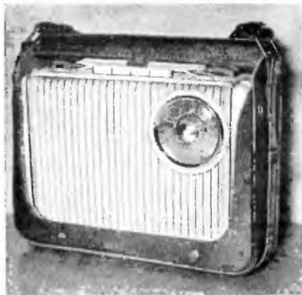
Der Kofferempfänger „Stern I“ vom VEB Stern-Radio Rochlitz ist in der NF-Stufe mit Transistoren bestückt. Die Gleichspannung für die HF-Röhren wird durch einen Transverter gewonnen.
