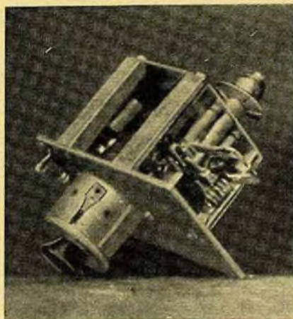
Bild 1: Innenansicht der HF-Einheit. Zu erkennen ist das Lechersystem mit Abstimm-drehkondensator, Rückkopplungskondensator, Parallelkondensator und Anodendrossel
