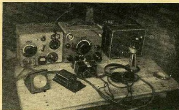
Der „Fuchs“ von DM 3 KKF. Links 20-W-Sender, mitte Frequenzmesser mit Mithöreinrichtung, davor NFM-Zusatz und rechts Netzteil, davor das Mikrofon.
