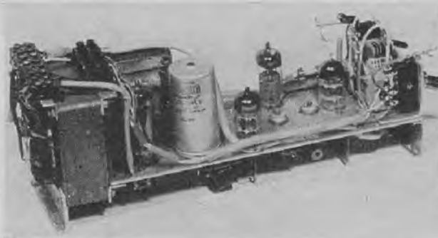
Ansicht des Bausteines für Sender und Netzteil (links) und Untersicht des gleichen Bausteines (rechts).
