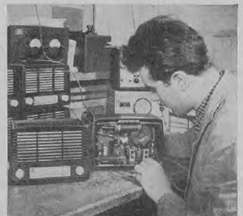
Zu Bild 10: Die „Minorette“, in gedruckter Schaltungstechnik hergestellt, ist das ideale Gerät als Zweitempfänger. Bevor die Geräte das Werk verlassen, werden sie von dem Endprüfer auf „Herz und Nieren“ geprüft.
