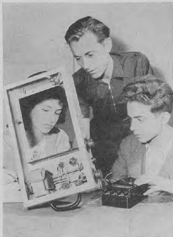
Zu Bild 4: Das ist kein neuer Fernsehempfänger, sondern Kam. Köstner erklärt den jungen Kameraden die Fehlersuche am Netzteil des im Bau befindlichen KW-Empfängers.
