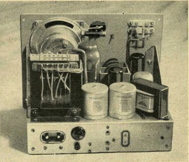
Bild 6: Auf dem Chassis erkennt man die Anordnung der einzelnen Bauelemente. An der Frontplatte erkennt man rechts oben die Buchsen für Antenne und Erde und links den Umschalter für den Lautsprecher.
