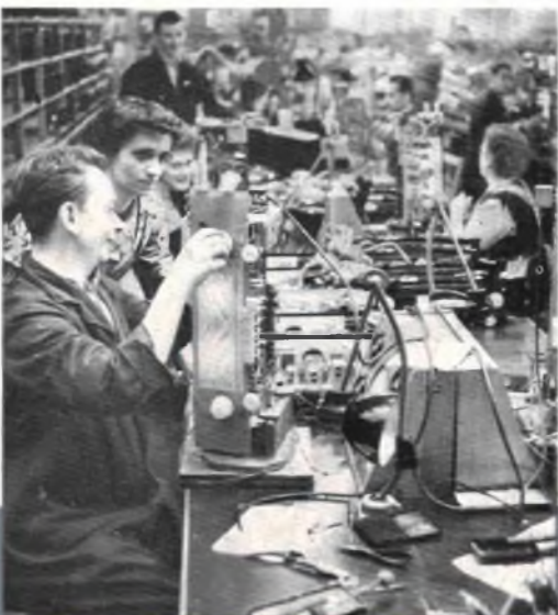
◀ Ab 1961 wird der VEB Funkwerk Dresden alle Erzeugnisse mit dem Gütezeichen „Q“ ausliefern. Auf dem Bild das Band „Grohmann“, wo die Chassis für den Rundfunksuper „Dominante“ hergestellt werden
