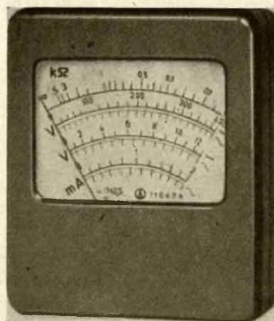
Multiprüfer für Gleich- und Wechselstrom des VEB Gerätewerk Karl-Marx-Stadt
