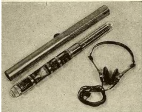
Bild 2: Strahlungsindikator mit Neunfach-Zählrohr und akustischer Anzeige
