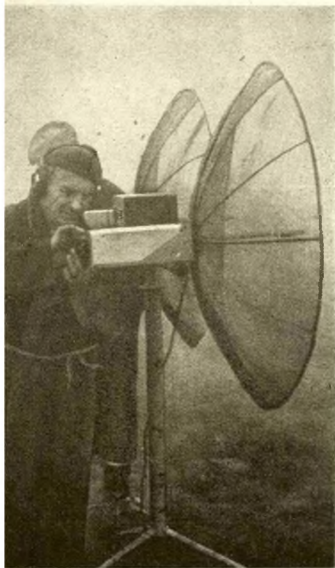
Bei kaltem und nebligem Regenwetter wird bei OK 1 KST eifrig die Gegenstation gesucht. Empfänger und Sender für 1215 MHz sind getrennt aufgebaut
