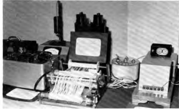
G. S. Litwin, ein Arzt aus Kasan, konstruierte diesen Fernsehastaster für Mikroskopaufnahmen. Es wird eine 15000fache Vergrößerung erreicht. Das Bild für den Betrachter kann drahtlos oder im Kurzschlußverfahren übertragen werden
