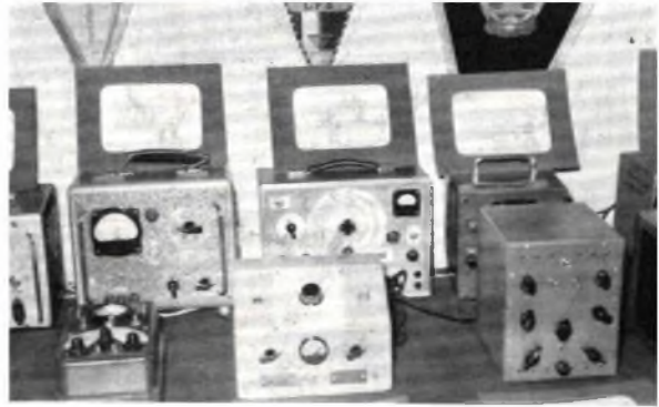
Eine ganze Längsseite des einen großen Saales nehmen die Meßgeräte ein, die von den Amateurkonstruktoren der DOSAAF gebaut worden waren. Unser Bild zeigt einige RLC-Meßbrücken in verschiedenen Ausführungsformen
