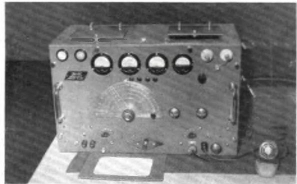
S. T. Awdejew, UN 1 BC, zeigte seine Eigenkonstruktion eines KW-Senders mit einer Leistung von 170 Watt für alle Bänder. Der Sender ist eingerichtet für CW-FONE und SSB mit Zusatzgerät. Der Modulationsverstärker ist eingebaut
