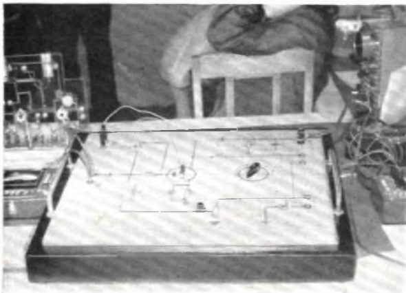
Sehr viel Aufmerksamkeit wird der Entwicklung von Lehrmitteln für die praktische Ausbildung gewidmet. Eine ganze Anzahl gut gelungener Lösungen waren zu sehen. Unser Bild zeigt eine Versuchsanordnung für Transistoren-Schaltungen Fotos: Schubert
