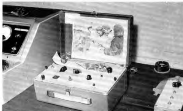
Besonders für Reihenuntersuchungen an Haustieren in der Landwirtschaft dient dieser transistorisierte Elektrokardiograf, den ein Konstruktionskollektiv in Kuibyschew entwickelte. Das Gerät ist inzwischen in Serienproduktion gegangen. Das Schreibsystem arbeitet mit elektrischen Funken
