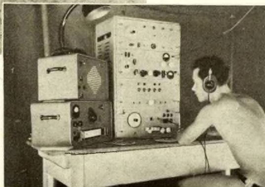
Die Station DM 3 XL mit dem OP Klaus Rosenhauer DM 3 ZXL. Unten im Gestell: Empfänger, darüber Netzteil für den Sender, dann Sender mit 2 EL 84 in der PA, oben der Frequenzmesser und Modulationsverstärker (fertig bis auf Ausgangsrafo)
