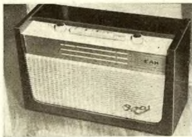
Der schnurlose Empfänger „Opal“ des VEB Elektroakustik Hartmannsdorf ist ein Transistor-Heimempfänger. Die zwei KW-Bereiche liegen bei 3 bis 7,4 und 9,3 bis 22 MHz
