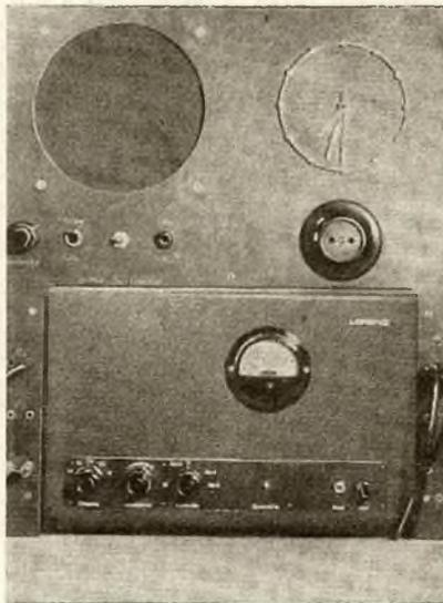
In der Arbeitsstellung wird diese Verbindung zweipolig getrennt. Um mit einer einmaligen Einstellung des Lautstärkereglers am MV 23 während eines QSOs auszukommen, wurde ein 100-Ohm-Entbrummer auf der Sekundärseite des Lautsprecherübertragers als feinstellbarer Lautstärkereglereingebaut (siehe Bild 3). Bei einem 3-Watt-Lautsprecher ergaben sich keine merklichen Verzerrungen. Erforderlich sind für dieses Relais zwei Arbeitskontakte.
