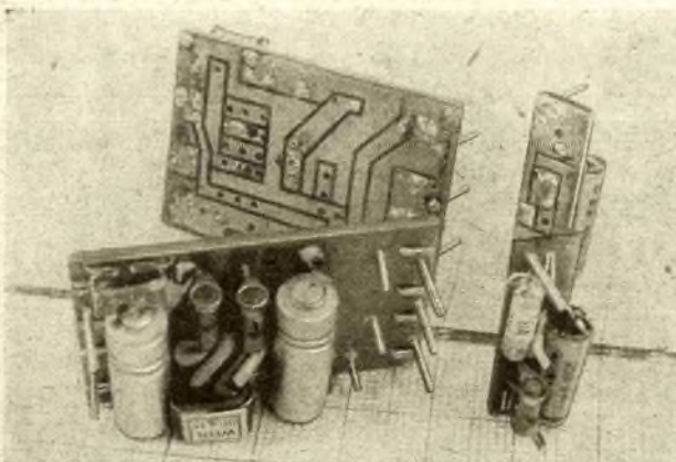
Bild 10: Verstärkerplatte mit aufsteckbarem Demodulator
