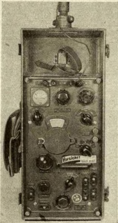
Bild 1: Ansicht der Frontplatte der Funkstation FK 1 (unten)
