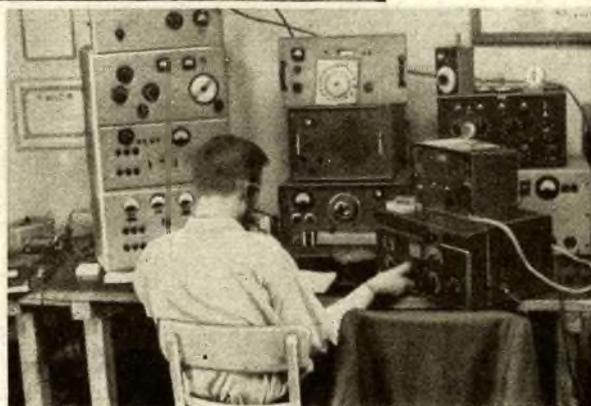
An der kleinen Station (100 W) arbeitet DM 3 KBM. Gehört wird mit einem „Köln“. Darüber steht der 10-m-Empfänger und über dem AQST steht der 10-m-Sender
