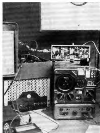
Bei OK 1 KEP wird ein kristallgesteuerter 2-m-Konverter verwendet, dem der Empfänger „EK“ nachgesetzt wird. Eingebürgert hat es sich, an einem Konverter zwei Nachsetzer zu betreiben
