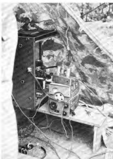
Die 2-m-Station von OK 1 KNR war sehr einfach aufgebaut. Der Konverter ist kristallgesteuert, als Nachsetzer dient das FuG 15. Die einfache PA-Stufe hat zweimal ECC 81
