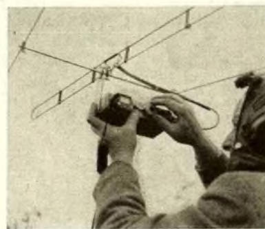
Bild 3: OK 1 HV beim Peilen mit dem Transistor-Fuchsjagdempfänger für 2 m von OK 1 VEX
