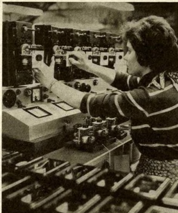
Die Mechanikerin Dorit Mattner prüft Relais vom Typ RZlw 3. Bei diesem Gerät wurde durch die neue Technologie eine Steigerung der Arbeitsproduktivität um 235 Prozent erreicht. Fünf Geräte kann Dorit jetzt gleichzeitig zum Eichen anschließen, früher mußte jedes einzeln geprüft werden. Foto: ZB
