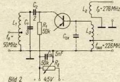
Bild 2: Schaltung des parametrischen Verstärkers mit induktiver Ankopplung des Pumpgenerators
