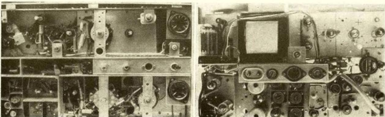
Der 2. Oszillator ist gut abzuschirmen, ebenso R<sub>ö</sub> 5, um Oberwellen zu vermeiden, welche Pfeifstellen im 2-m-Band hervorrufen können. Der NF-Verstärker fand auf einem 70 × 100 mm großen Chassis Platz (links unten im Bild 6b).
