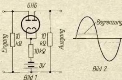
Bild 1: Einfacher Diodenclipper zur Erzeugung von Impulsen aus Sinusschwingungen (statt der 6 H 6 kann auch eine EAA 91 verwendet werden)
