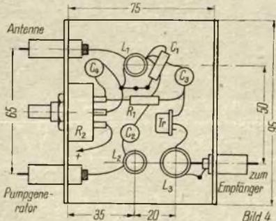
Bild 4: Aufbauskitze für die Anordnung der Bauelemente des parametrischen Verstärkers nach Bild 1
