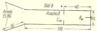
Bild 7–9: Maßskizze für L 29 (Anodenkreis der Treiberröhren), L 30 (Anodenkreis der PA-Röhren) und L 31 Antennenspule des Senders
