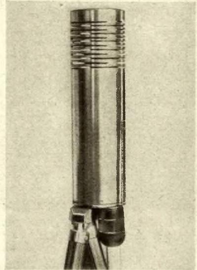
Bild 2: Ansicht des beschriebenen, betriebsbereiten Mikrofons mit eingebautem Vorverstärker
