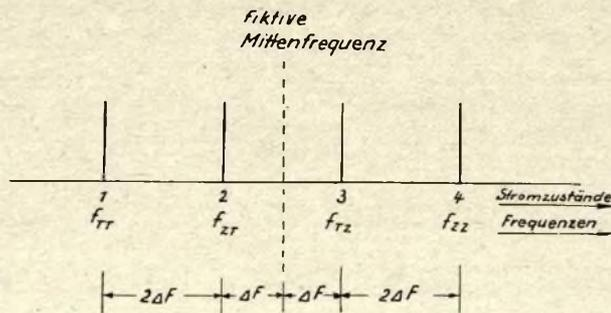
Bild 5: Prinzip des Duplex-Verfahrens
