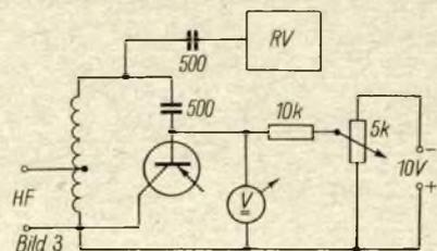
Bild 3: Meßschaltung zur Kapazitätsmessung des p-n-Übergangs einer Diode oder eines Transistors
