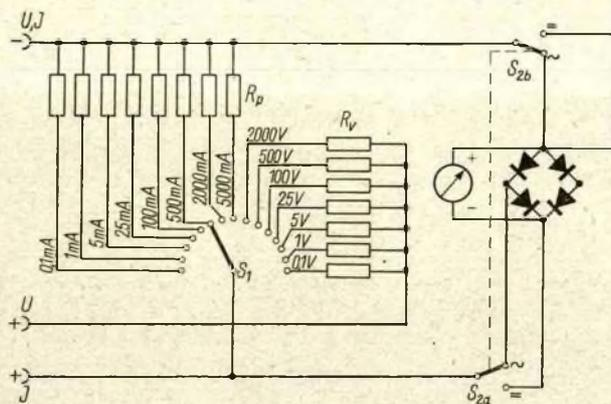
Bild 2: Prinzipschaltbild für einen Vielfachmesser. Die Werte der Widerstände lassen sich mit den angegebenen Formeln ermitteln. Die Werte sind vom verwendeten Meßwerk abhängig
