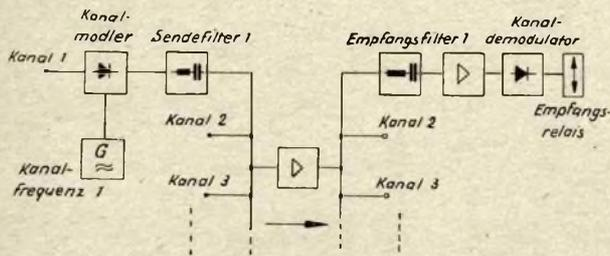
Bild 3: Blockschaltbild der Wechselstromtelegrafie (eine Richtung)
