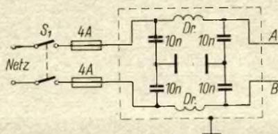
**Bild 3:** Schaltung des Netzeinganges des Stromversorgungsteiles mit vorschriftsmäßiger Netzverdrosselung
