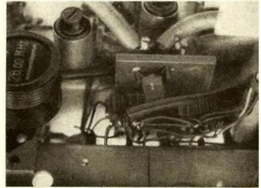
Bild 10: Ansicht des Sende-Empfangs-Umschalters
