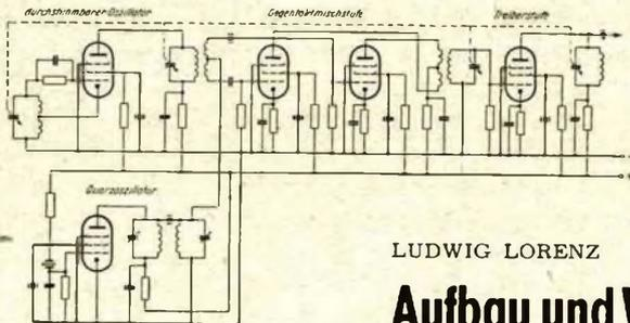
Prinzipschaltbild eines Mischsenders mit Gegentaktmischstufe
