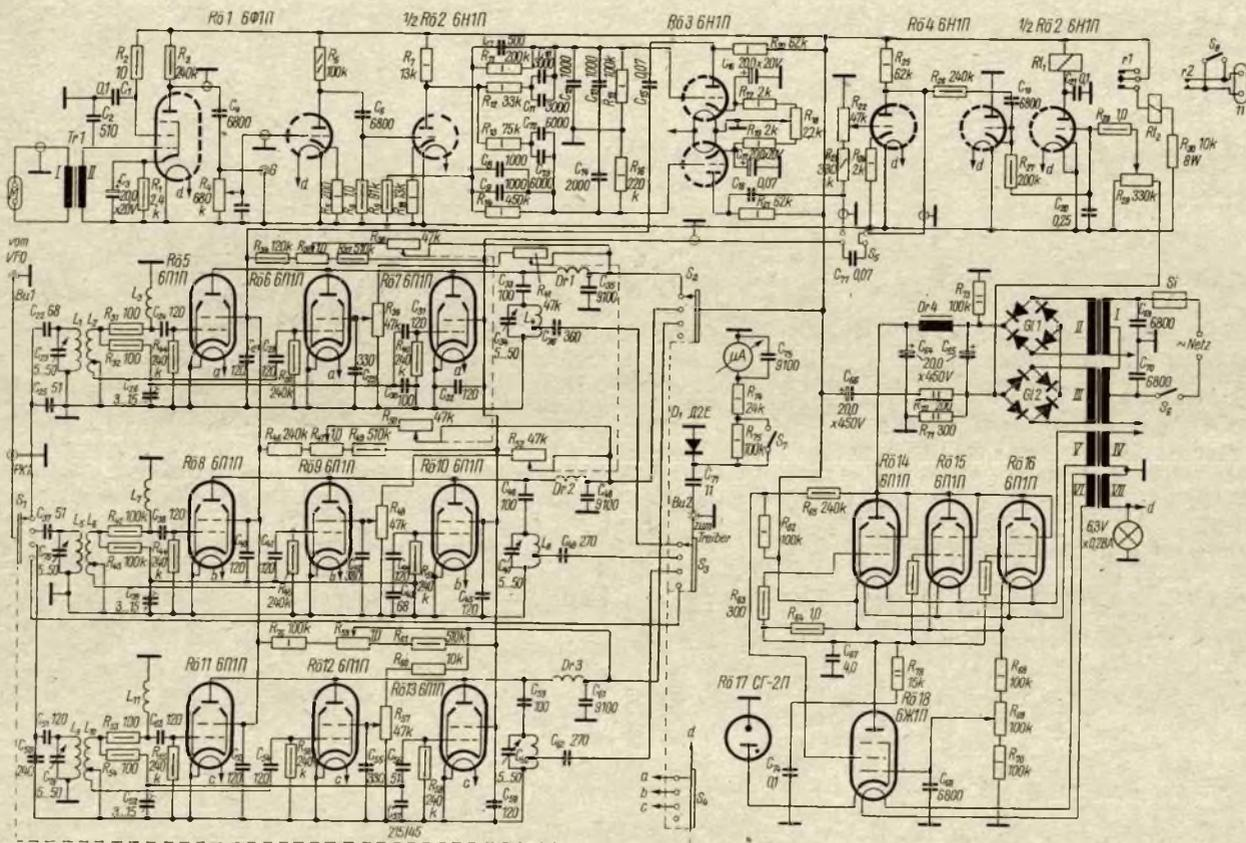
**Bild 2: Komplettes Schaltbild der SSB-Zusatz-einrichtung von UB 5 WF. Ein hochkonstanter Steuersender liefert die Arbeitsfrequenz**
