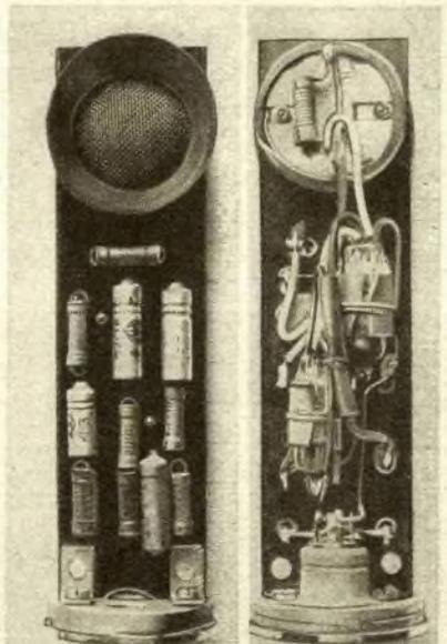
die Stromversorgung montiert. Ein Schalter ist dabei nicht notwendig. Durch Einstecken des Diodensteckers in die Dose im Mikrofon wird die Stromversorgung angeschlossen, das Gerät ist dann einsatzbereit. Der zweite Durchbruch wurde mit einem Fotostativgewinde zur Befestigung an Tisch- und Standstativen versehen. Der dritte Durchbruch dient der Verbindung des übergeschobenen Gehäuses mit dem Fuß.
