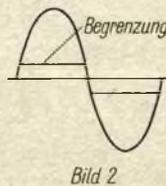
Schalt- und Röhrenkapazitäten keine frequenzabhängigen Glieder enthält, erzeugt er einwandfreie Rechteckimpulse bis zu den höchsten Tonfrequenzen, kapazitätsarmer Aufbau vorausgesetzt.
