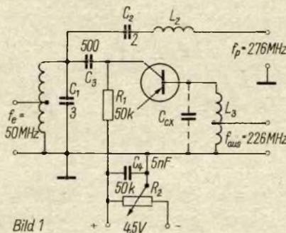
Bild 1: Schaltung des parametrischen Verstärkers mit Einspeisung der Pumpfrequenz über Serienkreis
