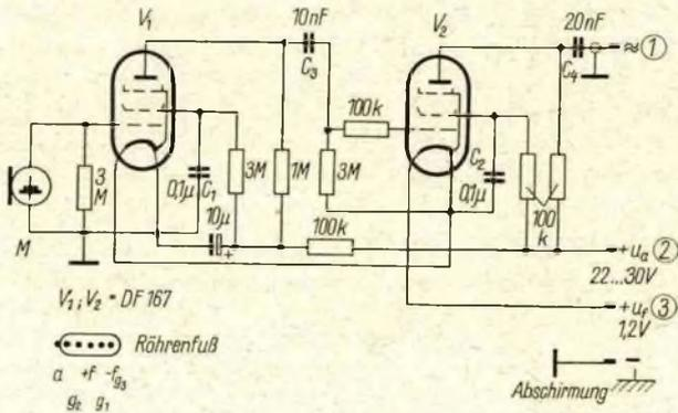
Bild 1: Schaltbild für den zweistufigen Mikrofon-Vorverstärker. Alle Widerstände 0,1 W; C 1 und C 2 = 65 V (Plast); C 3 und C 4 = 350 V (Keramik)
