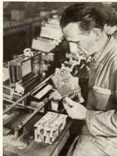
Mit einer eigens für diesen Zweck konstruierten Maschine werden die auf der Plattenunterseite hervorstehenden Anschlüsse einheitlich auf 3 mm Länge gekürzt. Wie der Bart des Mechanikers zeigt, eignet sich diese Konstruktion noch nicht zum Rasieren
