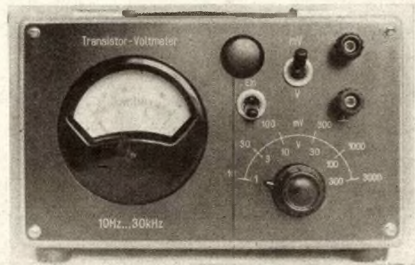
Bild 2: Ansicht der gravierten Frontplatte des Transistorvoltmeters
