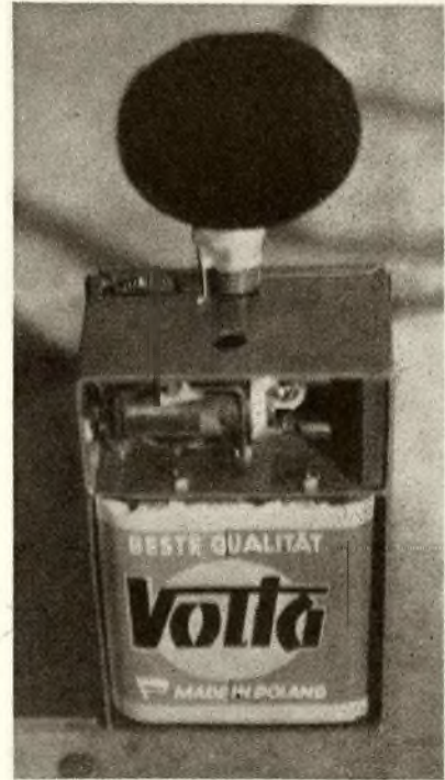
Bild 1: Vorderansicht des beschriebenen Gerätes mit Kommandorelais und Stromversorgung (4,5-V-Batterie)
