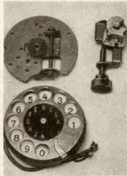
Bild 3: Das Bild zeigt die verwendete Nummernscheibe, darüber die Grundplatte und rechts ein fertiger Skalenantrieb
