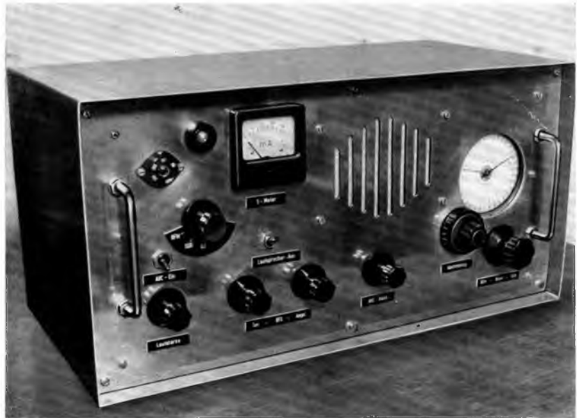
Bild 1: Vorderansicht des Amateur-Doppelsupers für alle KW-Bänder. Die Frontplatte ist sehr stabil ausgeführt. Die gravierten Beschriftungsschilder geben dem ganzen Empfänger fast ein kommerzielles Aussehen
