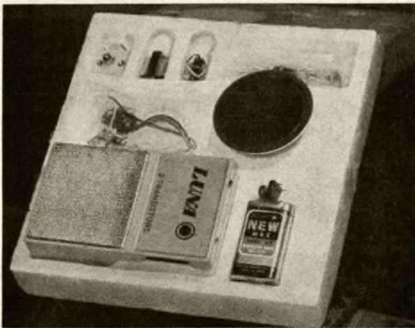
Bild 2: Nachahmerswert ist das Beispiel aus Japan, ein Baukasten für einen selbstzubauenden Transistor-Reflexempfänger
