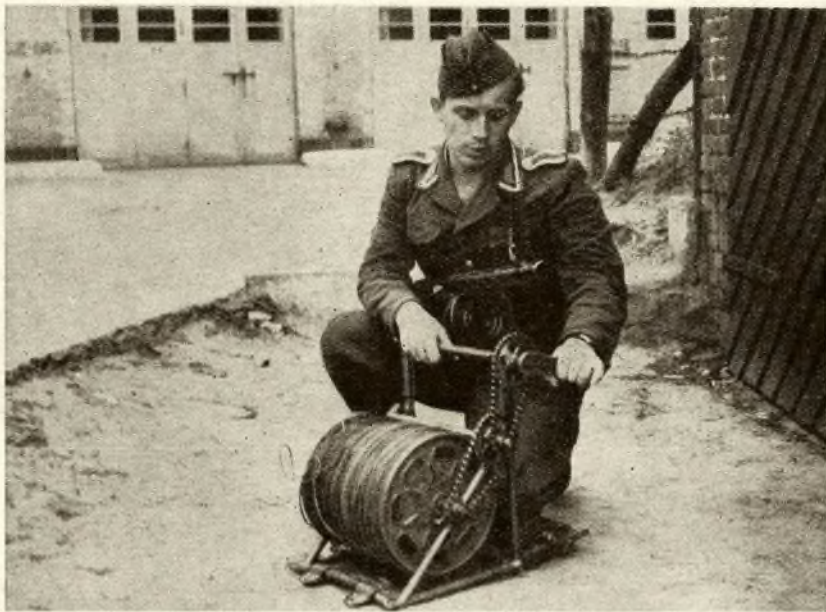
Ein Fernsprechunteroffizier der NVA führt das Auftrommeln des Kabels mit Hilfe einer Spindel vor.
