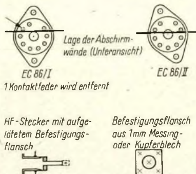
Bild 8: Mechanische Einzelheiten. Von der kleinen Abschirmwand werden zwei Stück benötigt. Bohrung in Wand I für 1-nF-Kondensator vorsehen. Das Oszillatorchassis wurde im „funkamateure“, Heft 4/1962, Seite 113, beschrieben
