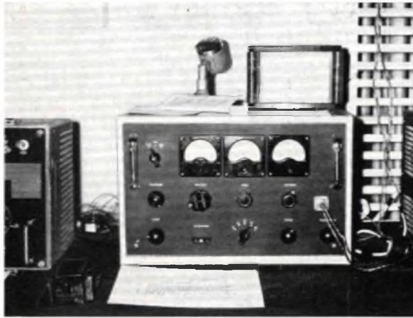
Bild 1: Mit 12 Röhren bestückt und auf allen KW-Bändern betriebsbereit ist der KW-Transceiver von UA 1 FA
