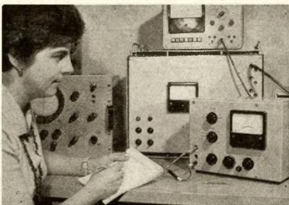
Bild 3: Ansicht eines mit TANDEL-Elementen und Transistoren bestückten Elektrometers, das im Physikalischen Institut der CSAV konstruiert wurde (Meßbereiche bis 10^{-10} A und bis 10^{11} Ohm)
