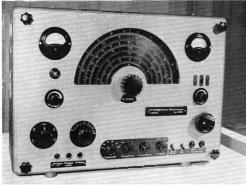
Der Rundfunkmechanikermeister August Müller, DM 2 AWO, stellte einen Meßsender-Wellenmesser vor. Das Gerät dient zur aktiven und passiven Frequenzmessung an HF-Geräten im Frequenzbereich zwischen 1 MHz und 30 MHz. Im Falle der aktiven Messung kann das Signal mittels eines eingebauten Tangenerators mit 5 verschiedenen Tonfrequenzen moduliert werden. Der Modulationsgrad ist einstellbar. Ein eingebauter Quarzoszillator dient zum Eichen des Gerätes. Dieses Gerät wurde vom OM Müller als Meisterstück angefertigt (links)
