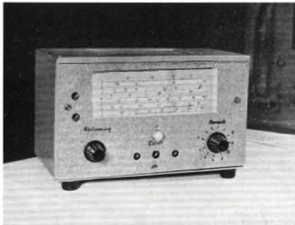
Wolfram v. d. Aa entwickelte dieses netzbetriebene Röhrenvoltmeter mit symmetrischem und unsymmetrischem hochohmigen Eingang, sowie Strommesser. Zur Anzeige dient ein 100 µA-Instrument. Nullpunkt und Vollausschlag sind getrennt eichbar (rechts)
