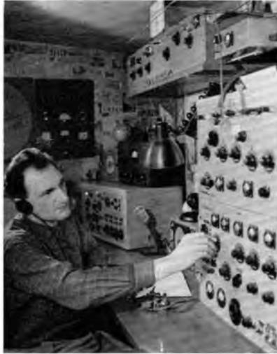
Unser Foto zeigt die Amateurfunkanlage von DM 2 BGO. Links steht der Doppelsuper mit 18 Röhren, rechts der Sender für eine Ausgangsleistung von 400 W. Oben befindet sich das Antennenanpaßgerät, das Colliusfilter und der Stehwellenmesser. Die Stromversorgung steht unter dem Tisch. Als Antenne steht eine 3-Band-Cubical-Quad zur Verfügung (Bild links)
