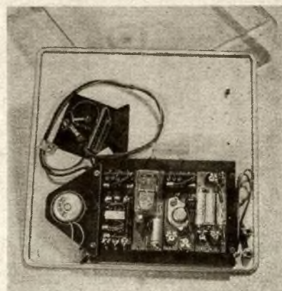
Bild 2: Auf einer Perminax-Grundplatte sind die Kontaktfedern aus Drahtstücken angeordnet, in die die Stifte der Baugruppen eingesteckt werden
