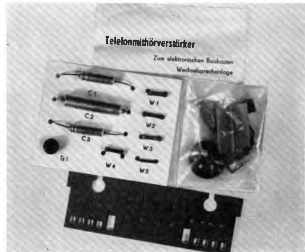
Bild 4: Wahlweise kann auch für das Emp- fangsteil ein Telefon-Mithörverstärker in die Hauptstelle eingebaut werden, um ank- ommende Telefongespräche lautstark wiedergeben zu können Fotos: MBD Demme
